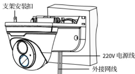
5. 安装支架上盖。先扣住上部，再扣底座左右两侧方孔，安装完成图如下所示。
