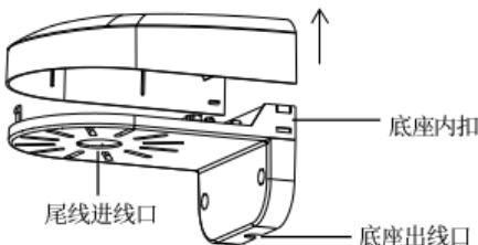
2. 将半球/海螺的固定底座取下，用螺钉固定在支架上，便于安装摄像头到支架上。可根据开孔大小决定是否使用垫片。
