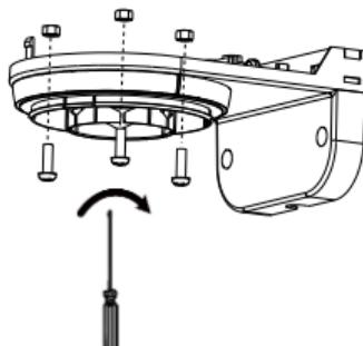
3. 安装支架上墙，外接网线从进线口穿入并从底座出线口理出，将电源板 220V 电源线从底座出线口理出，使用螺钉将支架固定上墙。
