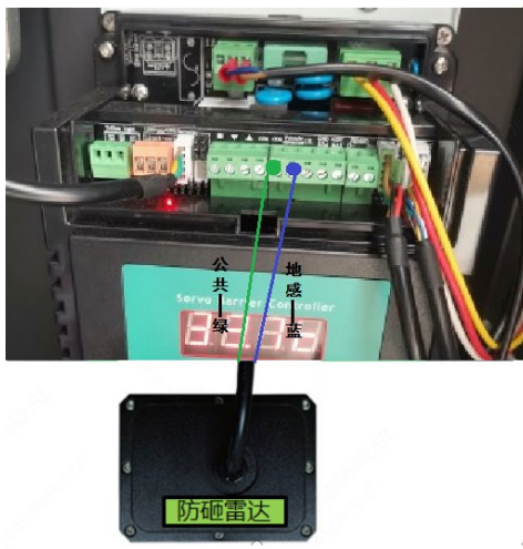
图6-11 DZSG 道闸控制板接线图
