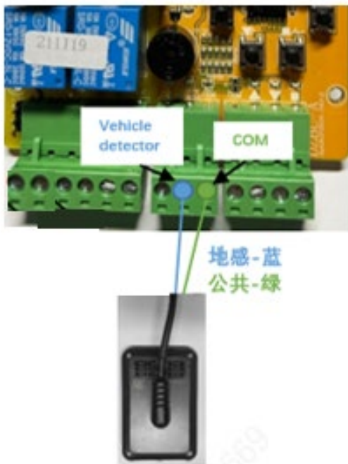
图6-8 DZB-A、DZS-A、DZSG-A 道闸控制板接线图
