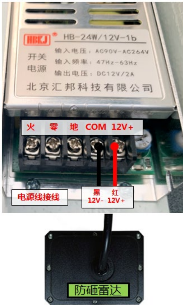
图6-5 配合 DZS 及 DZSG 道闸电源接线
