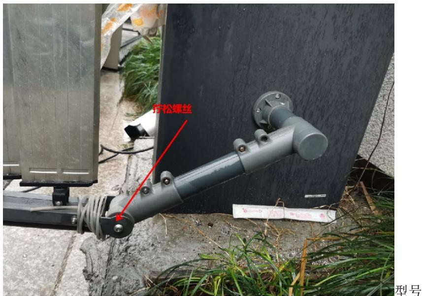
(2) 拧出闸杆夹板的螺丝与螺母，将杆件取出来；
