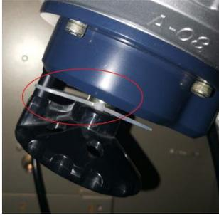
**步骤2** 拆道闸上盖，微按压杆子，将保险杠放入进去，将保险杠用扎带扎紧；
