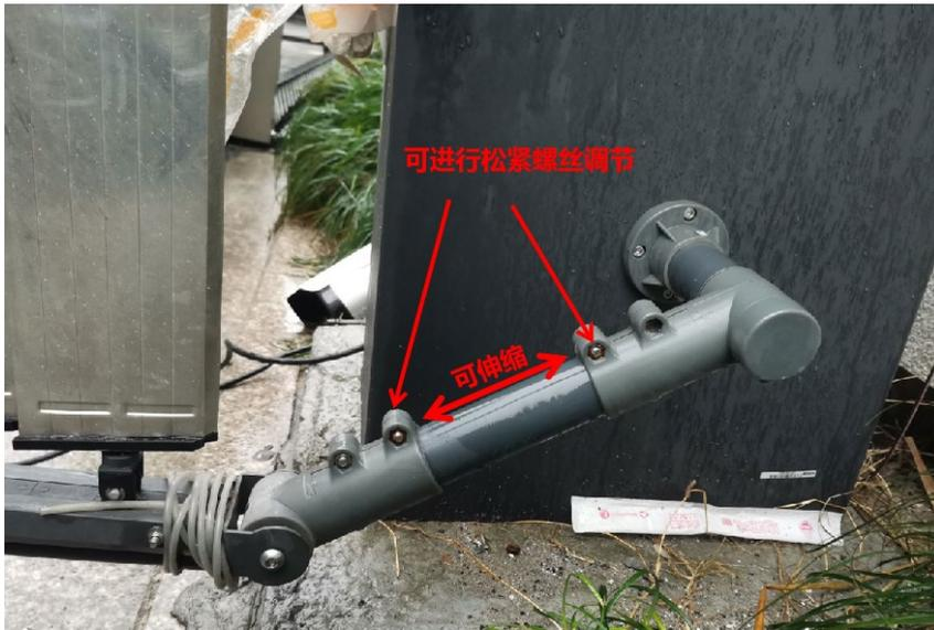
**步骤2** 拆道闸上盖，剪掉保险杠上扎带，微按压杆子，将保险杠取出，将取出的保险杠要妥善保管，在强风天气拆卸道闸杆是会用到。
