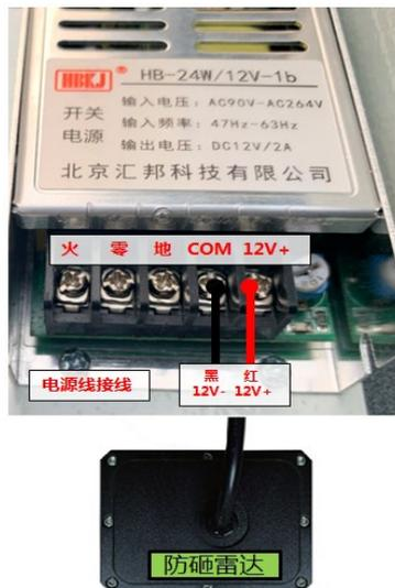
图4-7 防砸雷达信号接线
