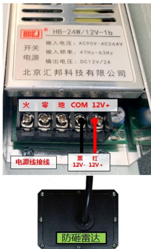
图3-4 “A1” 版本 DZS 道闸防砸雷达电源接线
