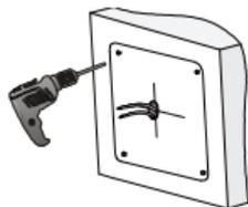
2. 在打孔位置安装膨胀螺栓，并敲击固定，保证膨胀螺栓无松动。
