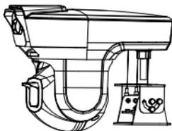
3. 将设备尾线与施工线连接好后塞回吊装支架，然后通过钣金的 3 颗内六角螺钉将步骤 2 组装好的设备固定在吊装支架上。
