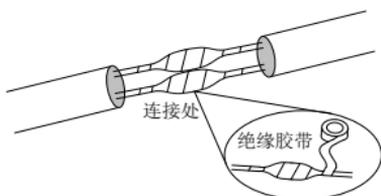
2. 用自粘性防水胶带对线缆进行防水处理。
