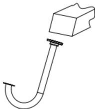
2. 将设备尾线穿过钣金，通过 3 颗螺钉将摄像机固定在钣金上。
