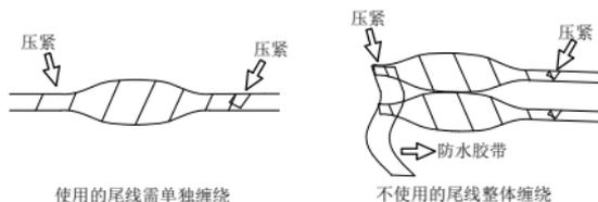
3. 用随机附带的防水套件对网线进行防水处理，如图所示依次将防水套件套在网线上。
