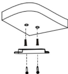
3. 将设备抵于安装片上，按图示方向旋转底座，即可将设备底座卡在安装片上。
